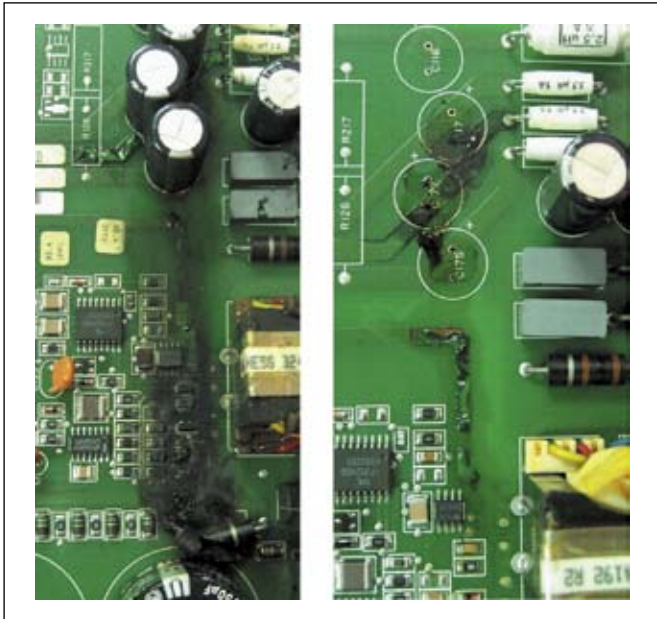
Рис. 6. Разрушение печатных плат и элементов вытекшим из конденсаторов электролитом
