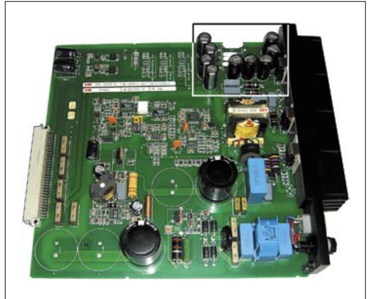
Рис. 7. Источник питания типа 316NN63 микропроцессорных реле серии RE*_316 (ABB) (выделена группа конденсаторов, дренаж электролита из которых приводит к массовым отказам источников питания)
