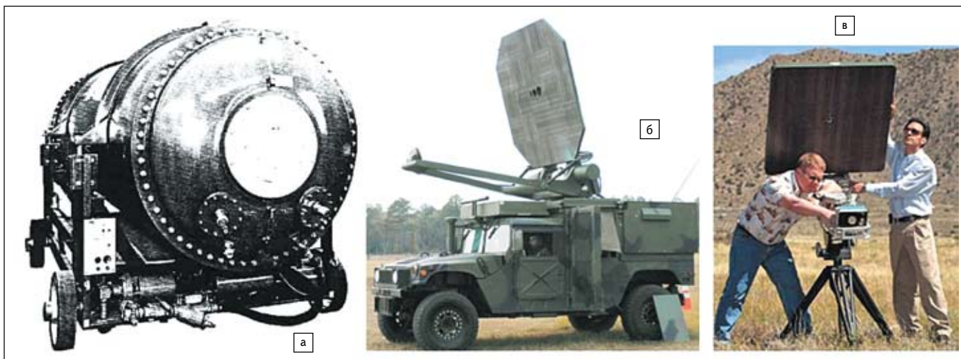
Рис. 36. а) Сверхмощный передвижной генератор высоковольтных импульсов FEBETRON-2020 (выходное напряжение 2.3 МВ, выходной ток 6000 Ампер); б) мощный СВЧ-генератор направленного действия, смонтированный на автомобиле; в) мощный СВЧ-генератор направленного действия переносного типа
