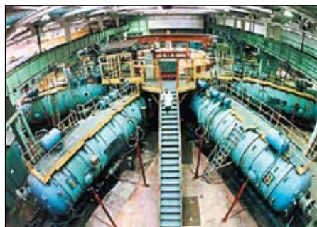
Рис. 35. Установка «Ангара-5-1» для генерации импульсов сверхвысоких электрических мощностей
