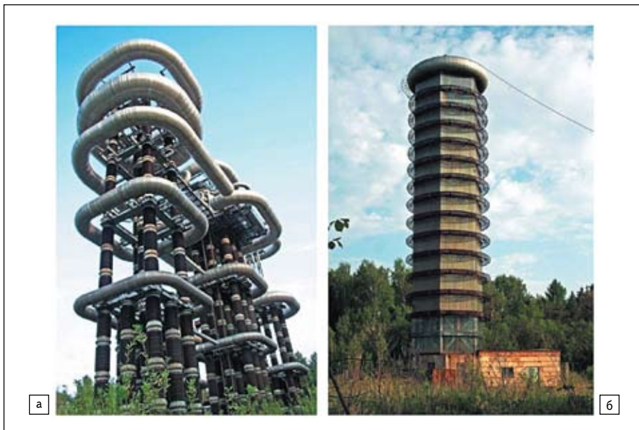
Рис. 31. Экспериментальное оборудование Истринского филиала Всероссийского электротехнического института: а) установка КТ3-МВ; б) ГИН-9МВ
