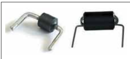
Рис. 2. Миниатюрные фильтры на основе ферритовых элементов (ФЭ), предназначенные для монтажа на печатной плате
