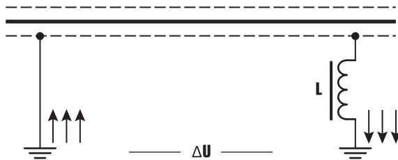
▲ Рис. 5. Предлагаемый вариант заземления экранов контрольных кабелей
