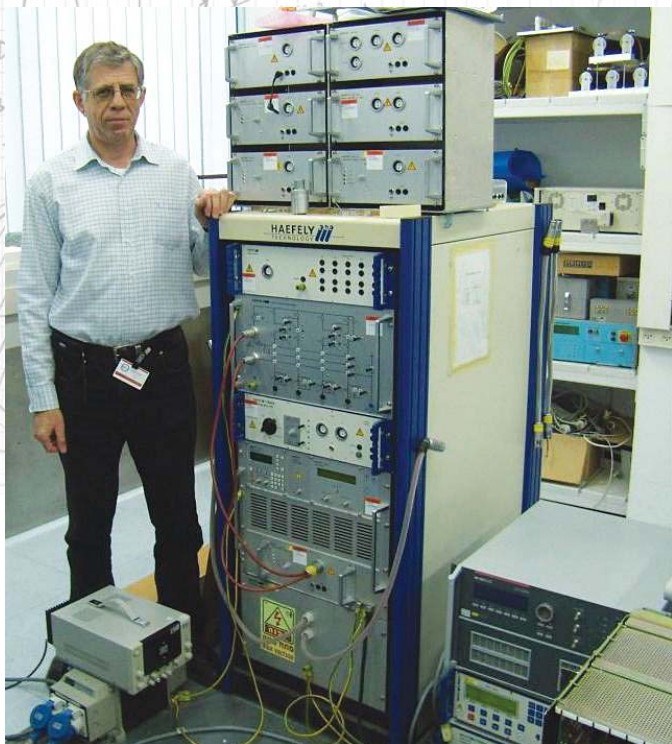
Рис. 8. Комплект оборудования для испытаний электронных приборов на электромагнитную совместимость
