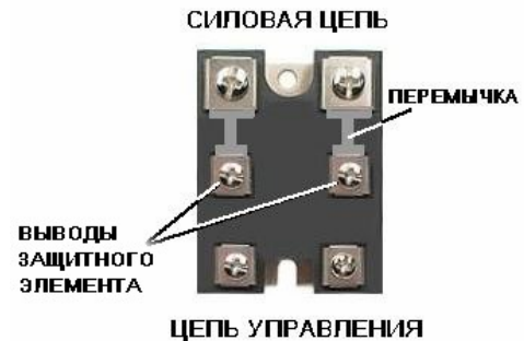
Рис. 6. Предлагаемая конструкция твердотельного реле с выведенными наружу выводами защитного элемента, подключаемого к клеммам силовой цепи посредством съемных перемычек.
