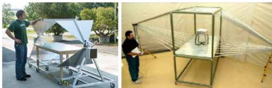
Рис. 4. Компактные стенды для испытания электронной аппаратуры на устойчивость к воздействию ЭМИ ЯВ, производимые различными компаниями
