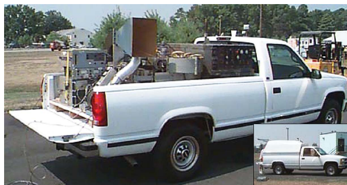
Рис. 4. Источник направленного сверхвысокочастотного излучения смонтированный в пикапе на базе легковушки с пластмассовым кунгом
