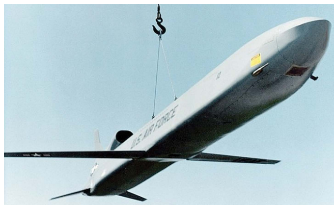
Рис. 2. Американская крылатая ракета AGM-86B ALCM компании Boeing с электромагнитной боевой частью (проект CHAMP).
