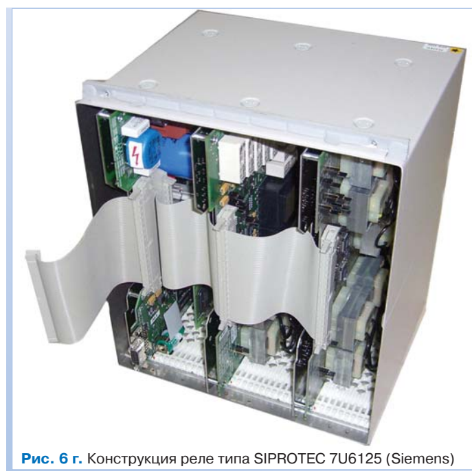
Рис. 6. Различные конструкции МУРЗ с выдвижными платами
