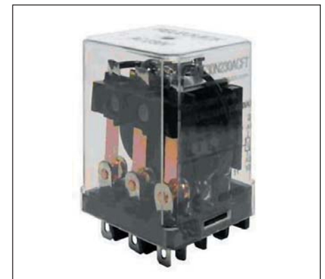
Рис. 10. Реле типа RME-FT-1 с одним замыкающим контактом с тройным разрывом, способным коммутировать постоянный ток до 3 А в индуктивной нагрузке при напряжении 220 В (производитель: RELEQUICK S. A.)
