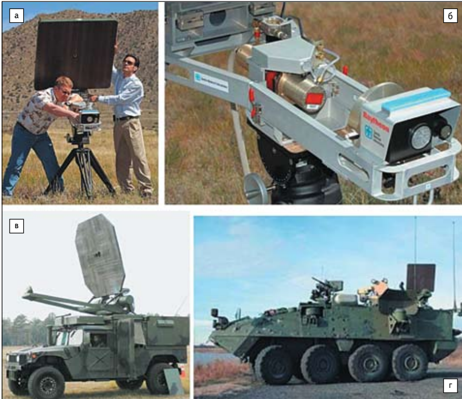
Рис. 6. а, б) Компактный источник мощного направленного ультракоротковолнового (95 ГГц) излучения, разработанный американской Sandia National Laboratories с использованием технологий компании Raytheon; в, г) мощные источники направленного излучения, смонтированные: в) на шасси джипа Hummer; г) на шасси БТР Stryker
