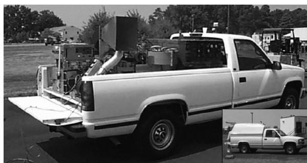
*Рис. 2. Источник направленного сверхвысокочастотного излучения, смонтированный в пикапе на базе легковушки с пластмассовым кунгом*
