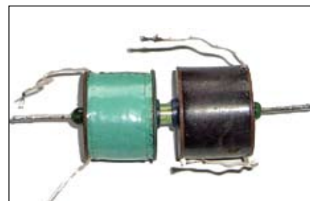
Рис. 2. Внешний вид макета реле переменного тока с герконом КЭМ-1 и двумя катушками, используемого в эксперименте
