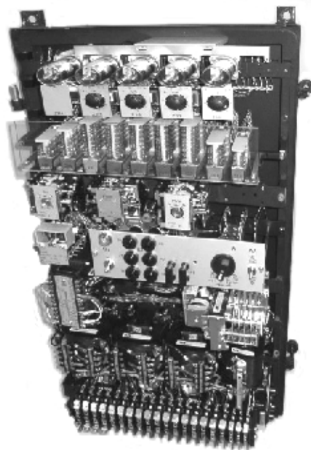
Рис. 4. Шедвр релестроения – электромеханическое реле трехступенчатой дистанционной защиты типа LZ31, выпускавшееся фирмой ASEA в 70-х годах и до сих пор надежно защищающих линии высокого напряжения 110 – 220 кВ во многих странах мира (со снятой крышкой-дверцей).
