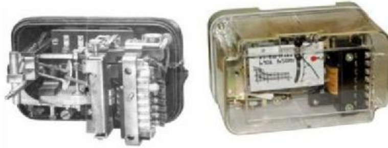
Рис. 5. Индукционные реле тока: слева типа RI, разработанного в 1918 году фирмой ASEA, справа – PT-80, до сих пор выпускаемого в России.
