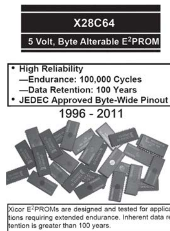
Рис. 4. Отказавшие через 15 лет эксплуатации элементы памяти EEPROM, выпущенные в 1996 году на фоне выдержек из технической документации на них, гарантирующей сохранение записанных данных в течение 100 лет.
