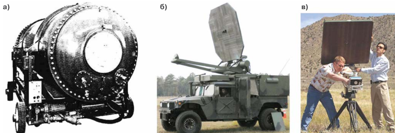
Рисунок 6. а) Сверхмоощный передвижной генератор высоковольтных импульсов FEBETRON-2020 (выходное напряжение 2,3 МВ, выходной ток 6000 Ампер); б) моощный СВЧ-генератор направленного действия, смонтированный на автомобиле; в) моощный СВЧ-генератор направленного действия переносного типа
