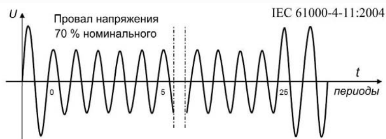
Рис. 1. Пример из стандарта IEC 61000-4-11. Провал напряжения до 70 % номинального уровня, длительностью 25 циклов (0.5 сек).
