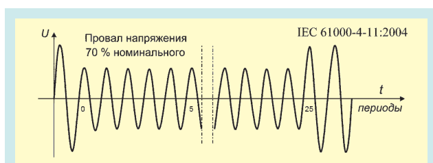
Рис. 1. Пример из стандарта IEC 61000-4-11. Провал напряжения до 70 % номинального уровня длительностью 25 циклов (0,5 с)
