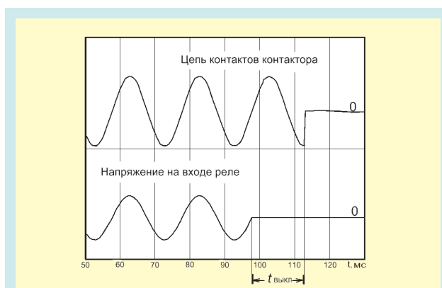
Рис. 5. Осциллограмма процесса отключения контактора, управляемого быстродействующим реле пониженного напряжения с тиристорным выходным коммутирующим элементом
