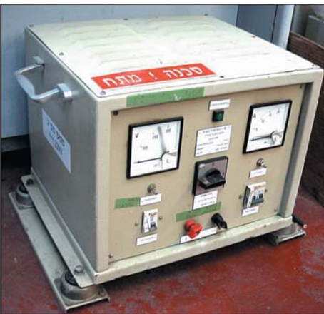
Рис. 12. Переносной ЗПА на ток 16 А и номинальное напряжение 230 В
