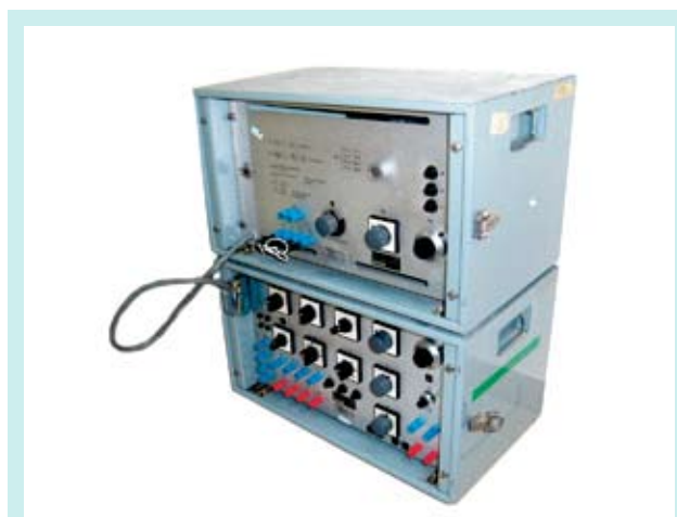
Рис. 2. Испытательная установка типа TURN-20 (ASEA) для проверки электромеханических реле защиты, содержащая наборы индуктивностей и активных сопротивлений
