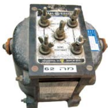
Рис. 1. Набор индуктивностей фирмы General Electric для проверки электромеханических реле защиты
