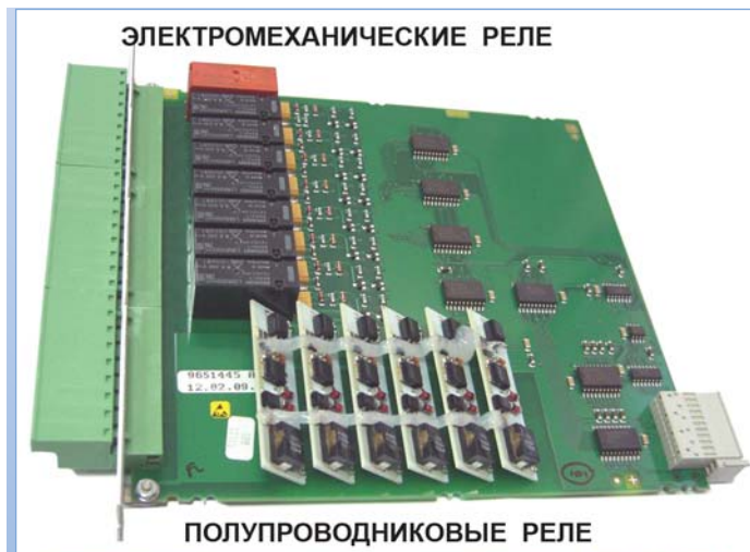
Рис. 16. Фрагмент модуля выходных реле в МУРЗ типов SEL-787, SEL-751, контакты которых зашунтированы варисторами
