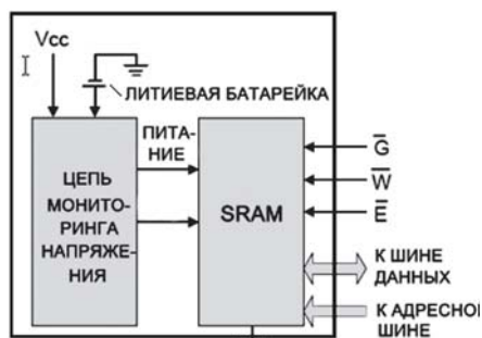
Рис. 39. Структура и внешний вид энергонезависимой памяти SRAM
