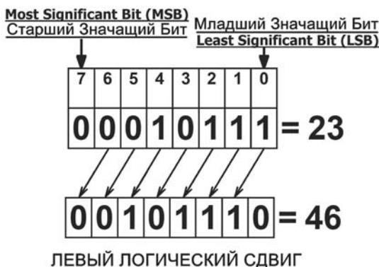
Рис. 46. Использование сдвигателя для умножения на 2. 10111 – двоичное изображение числа 23; 101110 – двоичное изображение числа 46
