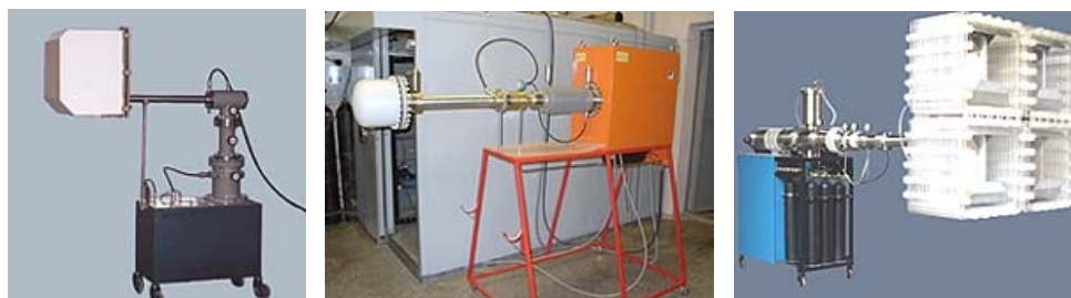
Рис. 2. Компактные генераторы мощных направленных волновых пучков сверхширокополосного электромагнитного излучения мощностью до 1 ГВт.
