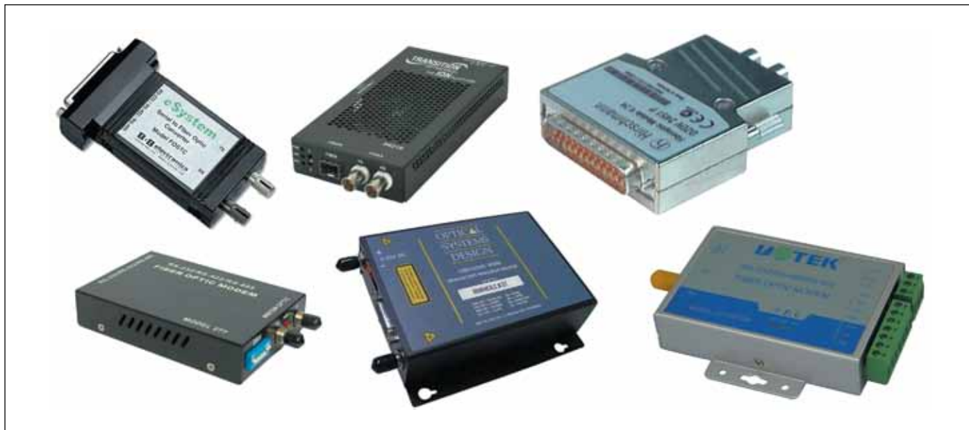
Рис. 1. Различные типы преобразователей электрических сигналов в оптические и обратно, пригодные для использования в системах телекоммуникации
