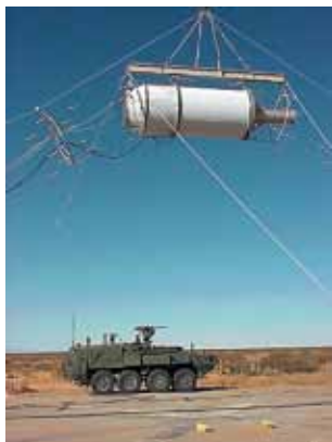
Рис. 8. Испытательный стенд для симуляции воздействия ЭМИ ЯВ на военную технику
