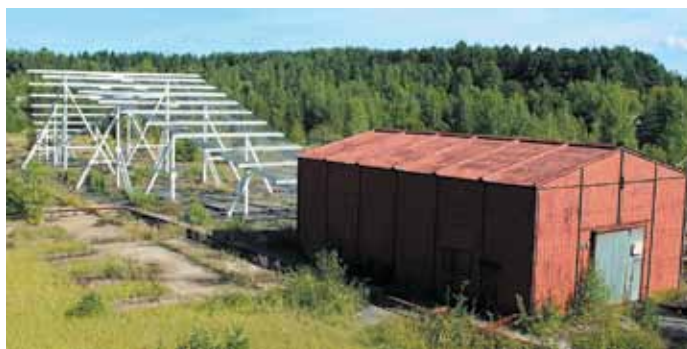
Рис. 9. Стационарный имитатор ЭМИ ЯВ «Аллюр»
