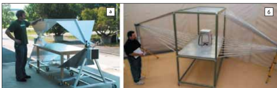
Рис. 10. Компактные стенды для испытания электронной аппаратуры на устойчивость к ЭМИЗ: а) Montena Technology; б) Applied Physical Electronics
