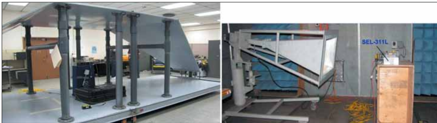
Рис. 2. Испытание МУРЗ типа SEL-311 на воздействие ПЭДВ на испытательных стендах полигона Пикатинни армии США в Нью-Джерси
