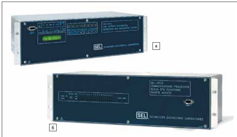
Рис. 1. Подвергнутые испытаниям на устойчивость к ЭМИ ЯВ: а) МУРЗ типа SEL-311L; б) контроллер для системы SCADA типа SEL-2032 производства Schweitzer Engineering Laboratories (США)
