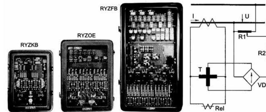
Рис. 7. Электромеханические реле дистанционной защиты различного типа фирмы ASEA и схема их пускового органа (производство 70-х годов)
