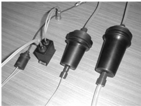
Рис. 1. Серия высоковольтных герконовых реле защиты на напряжения 15 - 75 кВ для мощного высоковольтного электронного оборудования военного и технологического назначения.
