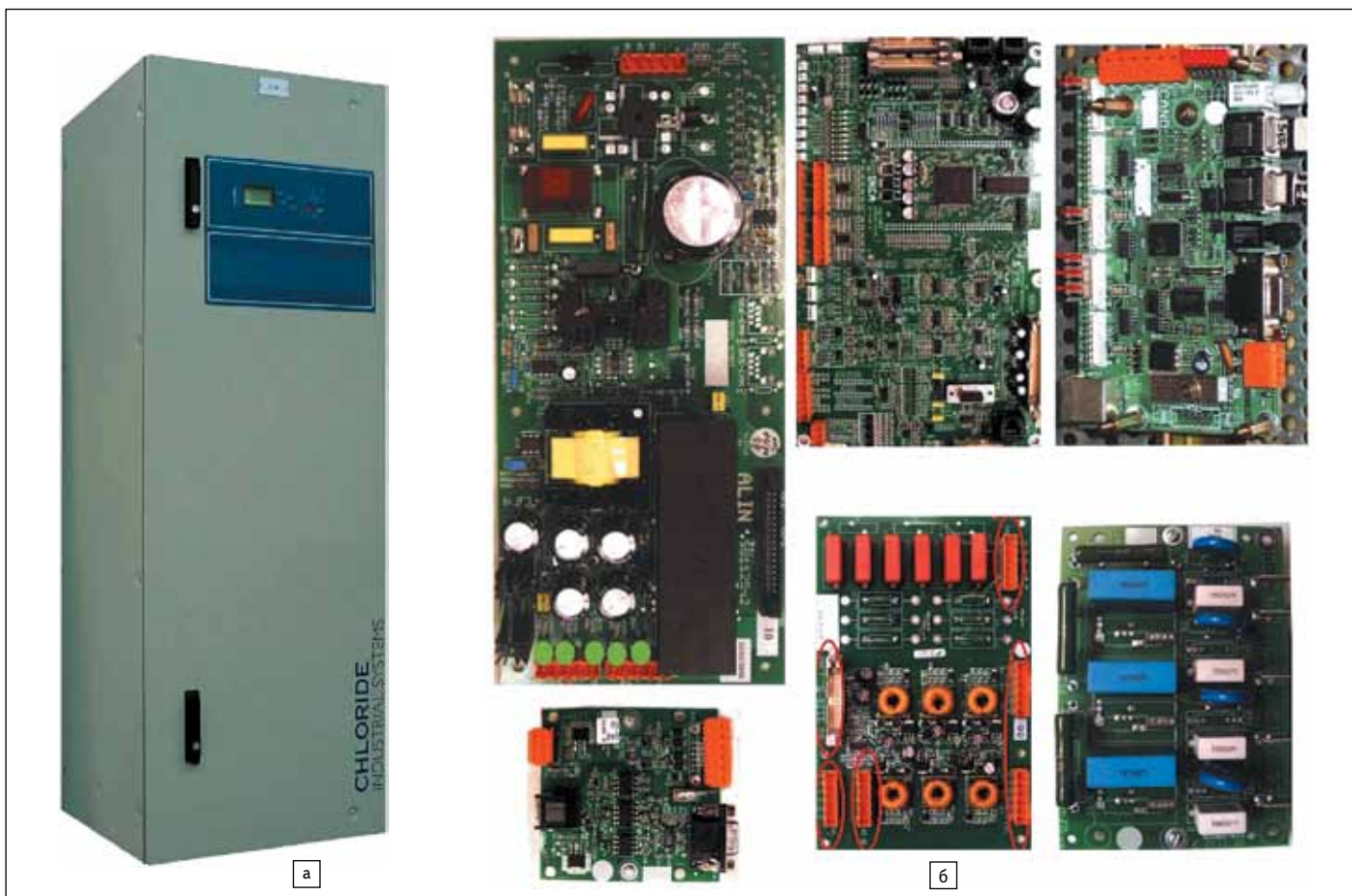
Рис. 7. а) ВЗПА; б) комплект основных модулей управления микропроцессорного ВЗПА
