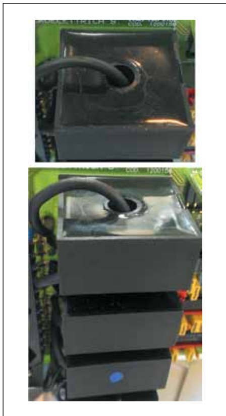
Рис. 7. Трансформаторы тока капсулированной конструкции с вторичной обмоткой, заложённой в пластмассовый корпус и залитой эпоксидным компаундом, отверждённым под вакуумом. Видна первичная обмотка, состоящая из одного витка гибкого изолированного провода
